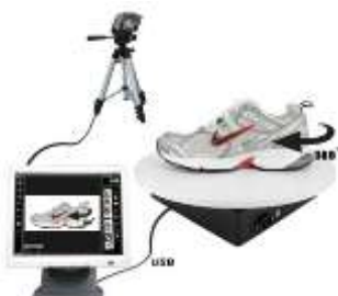
Aansluiting draaitafel en camera op computer
